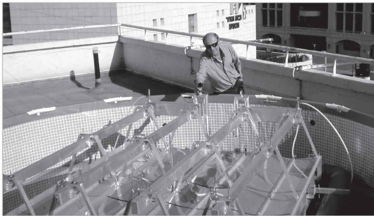
Sonne, Wasser, Strom: Prototyp einer schwimmenden Fotovoltaikanlage der israelischen Firma Solaris Synergy. Foto: Solaris Synergy
